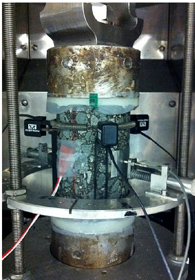
Figur 3: Exempel på mätupställning för konventionella cykliska belastningar. Fotot är taget vid ENTPE, University of Lyon.
